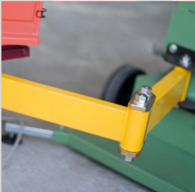
El brazo articulado es el instrumento que caracteriza a todas las máquinas MD DARIO. Consiste en un conjunto de juntas que permiten que la sierra gire con facilidad y en cualquier dirección.
