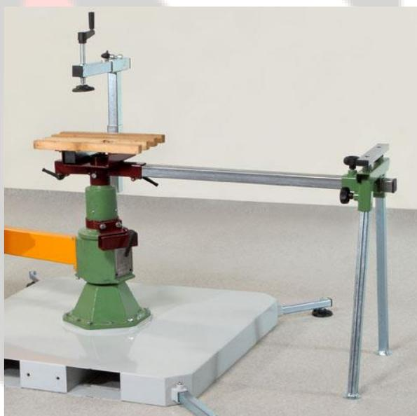
El soporte del material, con un bastidor con patas, permite soportar materiales duraderos.
